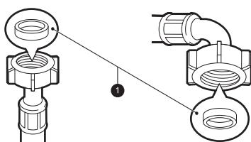
**Anslutning av slang till vattenkran****Anslutning av slang med skruvkoppling till kran med gänga**
